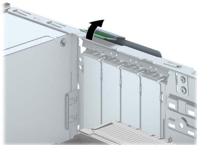
9. 新しい拡張カードを取り付ける前に、拡張スロット カバーまたは装着されている拡張カードを取り外します。
