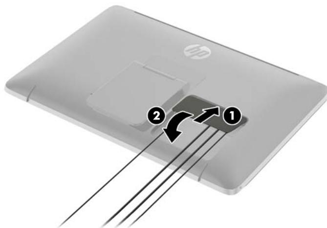
8. Collocare il monitor in posizione verticale ed estrarre il cavalletto per supportare il monitor.
