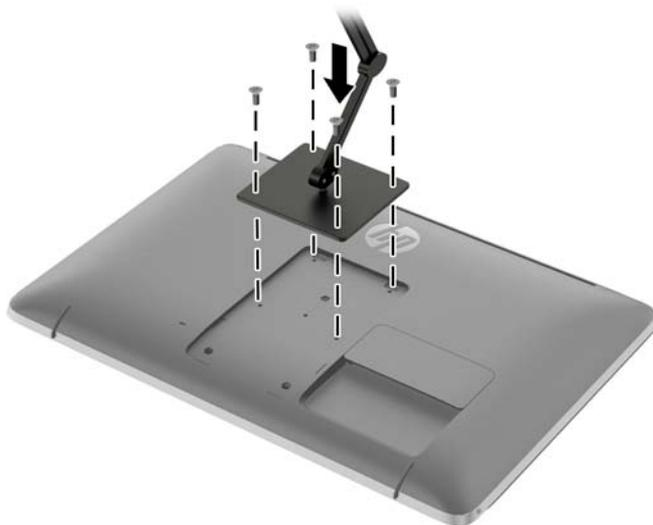
Per collegare il monitor ad altri supporti di montaggio, seguire le istruzioni incluse col supporto di montaggio per accertarsi che il monitor sia saldamente collegato.
