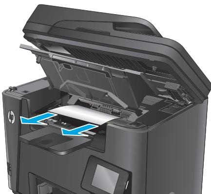
5. Закройте крышку для получения доступа к замятию.
