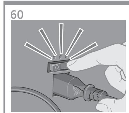
Τοποθετήστε το διακόπτη τροφοδοσίας στη θέση ενεργοποίησης, στην πίσω πλευρά του εκτυπωτή.
