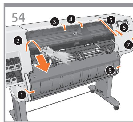
Αφαιρέστε τις τανίες συσκευασίας με σήμανση 1 έως 8 από το εξωτερικό του εκτυπωτή.
