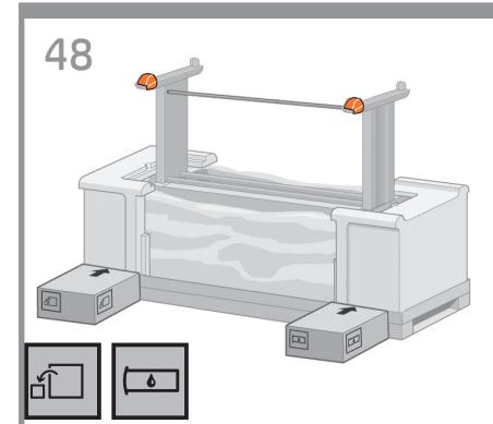
**Τοποθετήστε το εφεδρικό κούτι και το κούτι με τα αναλώσιμα στο πίσω μέρος του κουτιού του εκτυπωτή. Τα βέλη στα κούτια πρέπει να βλέπουν προς το κούτι του εκτυπωτή. Βεβαιωθείτε ότι το αντιολισθητικό υλικό είναι προσφραμσένο στις δύο πίσω ρόδες.**
