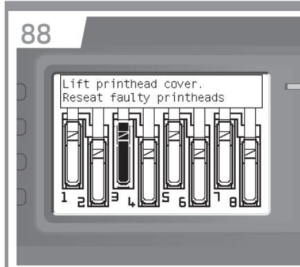
**EL** Εάν εμφανιστεί ένα μήνυμα “Reseat” [Επανατοποθέτηση] στον μπροστινό πίνακα, ελέγχετε αν όλες οι προστατευτικές ταινίες έχουν αφαιρεθεί και στη συνέχεια επανατοποθετήστε τις κεφαλές εκτύπωσης. Εάν το πρόβλημα εξακολουθεί να υφίσταται, ανατρέξτε στο CD/DVD HP Start-Up Kit [Κιτ εκκίνησης της HP].
