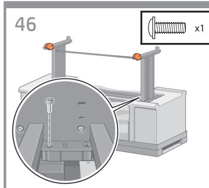
**Χρησιμοποιήστε μία βίδα για να συνδέσετε τη δεξιά πλευρά της βάσης στο μηχανισμό του εκτυπωτή. Βεβαιωθείτε ότι η βίδα έχει σφίξει καλά.**
