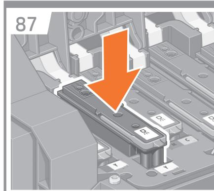
**EL** Βεβαιωθείτε ότι οι κεφαλές εκτύπωσης βρίσκονται στη σωστή θέση. Όταν τοποθετηθούν όλες οι κεφαλές εκτύπωσης, εμφανίζεται στο εξής μήνυμα στον μπροστινό πίνακα “Close printhead cover and window” [Κλείστε το κάλυμμα της κεφαλής εκτύπωσης και το παράθυρο].
