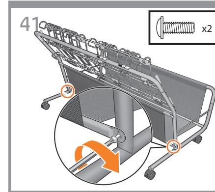
**EL** Εισαγάγετε μια δομική ράβδο μέσα από τη λαβή με το ύφασμα και στερεώστε την με δύο βίδες στην κατασκευή του υποδοχέα.
