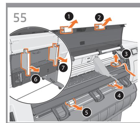
Ανοίξτε το παράθυρο του εκτυπωτή και αφαιρέστε τα στοιχεία συσκευασίας (1 έως 5) από το εσωτερικό του εκτυπωτή και τα δύο που βρίσκονται στο πίσω μέρος του εκτυπωτή.
