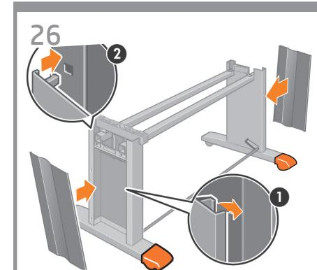
**Τοποθετήστε τα καλύματα του αριστερού και δεξιού ποδιού στο μπροστινό μέρος των ποδιών (1) και στη συνέχεια στερεώστε το πίσω άκρο (2) στη θέση του.**
