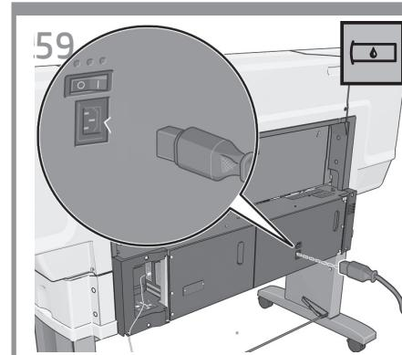
**EL** Συνδέστε το καλώδιο ρεύματος στο πίσω μέρος του εκτυπωτή και στη συνέχεια συνδέστε το άλλο άκρο στην πρίζα.
