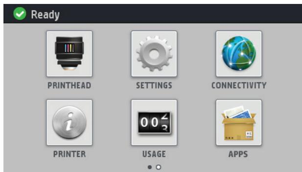
前控制面板有一個大型的中央區域，可顯示動態資訊及圖示。在左右兩邊，您可以在不同時機看到多達六個固定圖示。這些圖示一般不會全部顯示。
