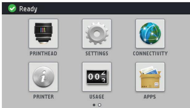
前面板有一大块中央区域，可用以显示动态信息和图标。在左右两侧，您可以在不同情况下看到最多 6 个固定图标。通常情况下，它们不会同时显示。
