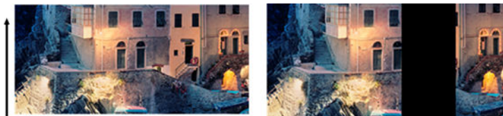
Originele scan beïnvloed door een defecte CIS-module
