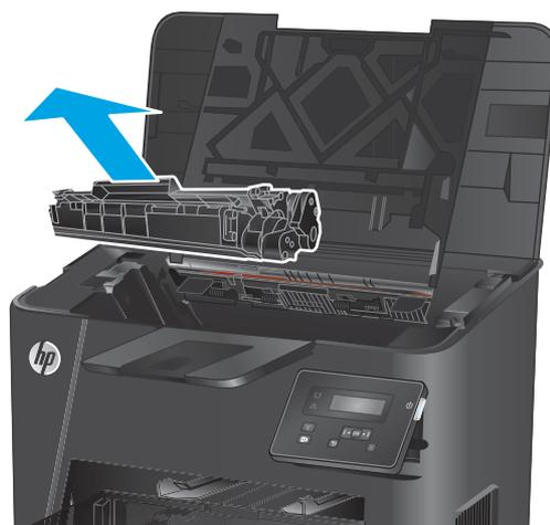
3. Retire de su embalaje el cartucho nuevo de t ner. Coloque el cartucho de t ner usado en el envase para reciclarlo.
