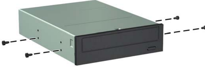
Şekil 2-51 Optik Disk Sürücüsüne Kılavuz Vidaları Takma
