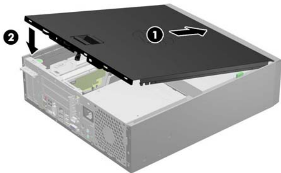
图 2-2 重新装上计算机检修面板
