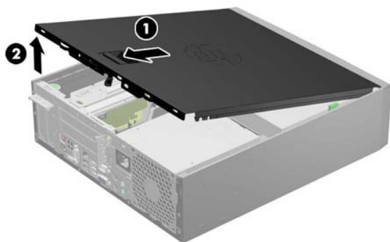
图 2-1 卸下计算机检修面板
