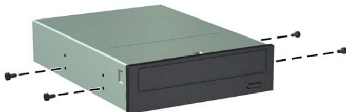
图 2-51 在光驱中安装导向螺钉
