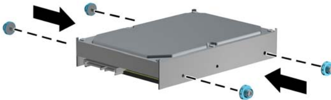
Figura 2-66 Instalación de los tornillos guía en la unidad de disco duro primaria
