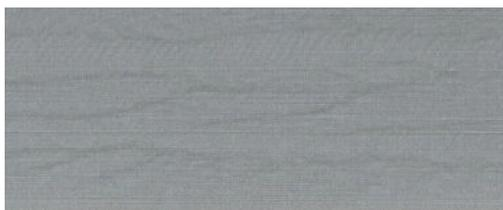
Las venas son bandas horizontales onduladas producidas por un error de colocación de puntos (DPE, “dot placement error”) inducido por el aire. En los casos extremos, las venas producen en la imagen una apariencia de veteado de madera. El problema se produce principalmente en los trabajos de impresión con ajustes de baja calidad y velocidad rápida. No sucede cuando el ajuste personalizado de calidad de impresión se establece en “óptima”.
