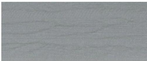
エアロワームは、波打っている水平方向の帯状のムラで、空気により引き起こされる DPE (ドット配置エラー) です。場合によっては、エアロワームによってイメージに木目が現れます。低品質および高速で設定された印刷ジョブで最も一般的に発生します。カスタム印刷品質設定が [高品質] に設定されていると、発生しません。
