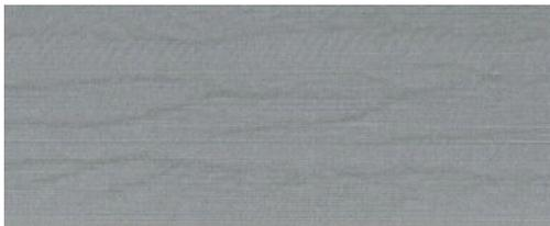
螺紋是由空氣引起的點陣布局錯誤 (DPE) 所產生的波浪形水平條紋。在極端情況下，螺紋使圖像出現木紋外觀。這種問題往往發生在設置進行高速低質量打印的打印作業中。將自定義打印質量設置設為“最佳”時，不會出現此問題。
