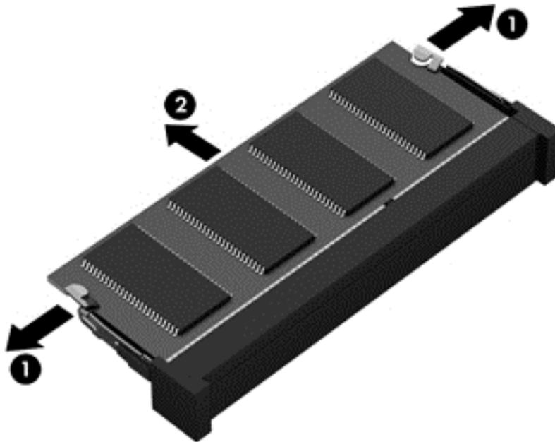
Bewahren Sie Speichermodule nach dem Entnehmen in einem elektrostatikgeschützten Behälter auf.
