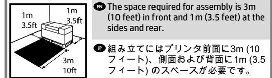
**ZHCN** 要进行组装，需要打印机前面有 3 米（10 英尺）、侧面和后面各有 1 米（3.5 英尺）的空间。
