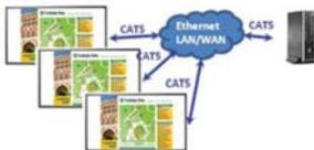
Das Bild kann mit der View Span "Display Resolution"-Dialogbox simultan über alle Displays erweitert werden.
