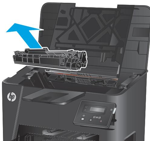
3. 取出碳粉匣區域中的任何卡紙。用雙手取出卡紙，以免紙張破裂。
