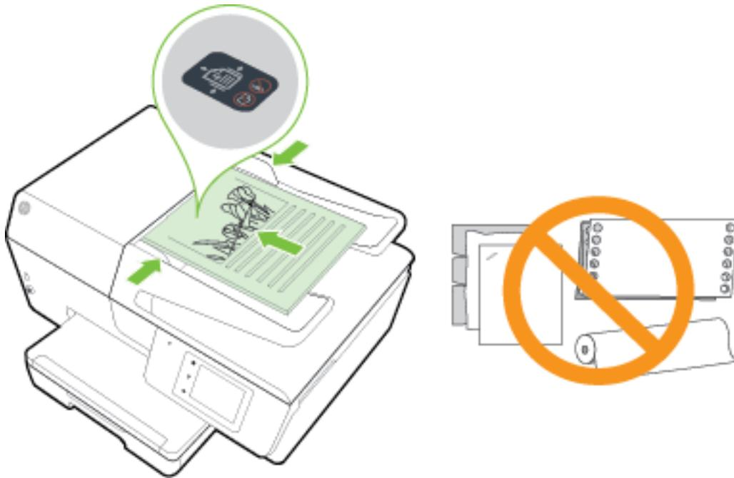
2. Deslice las guías de ancho de papel hacia dentro hasta que entren en contacto con los bordes izquierdo y derecho de la hoja.
