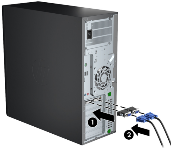
Abbildung 3-4 Anschließen der Kabel an der Workstation
