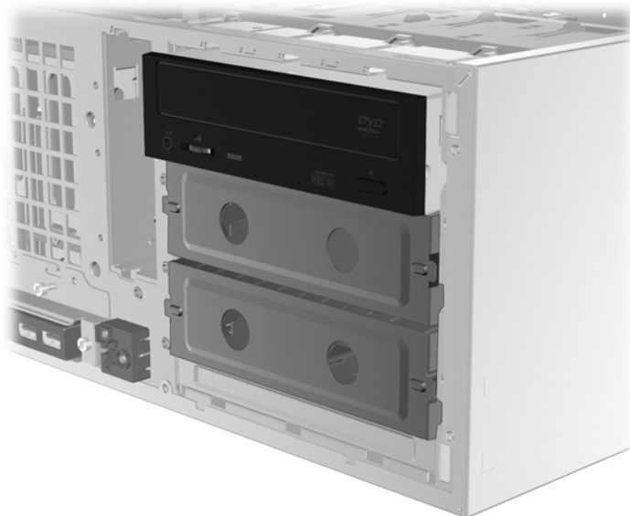
Abbildung 3-9 Erneutes Installieren des optischen Laufwerks
