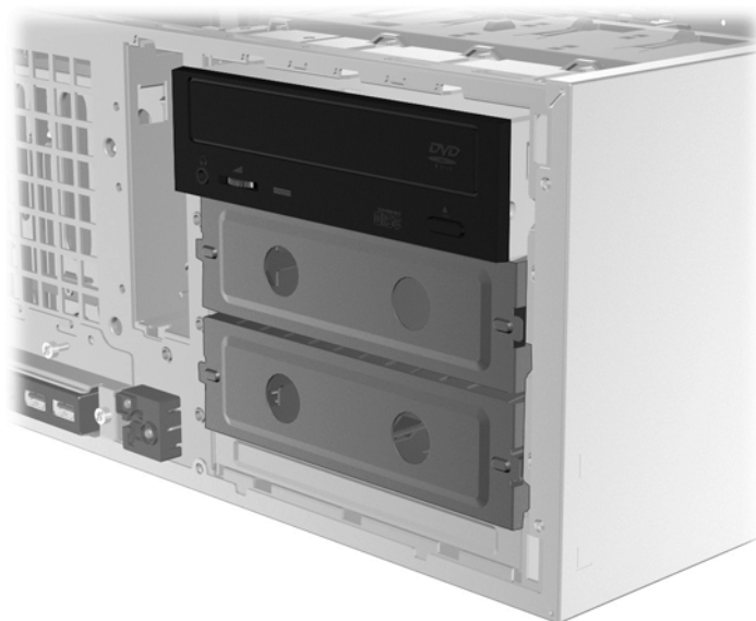
Obrázok 3-9 Opätovná inštalácia optickej jednotky
