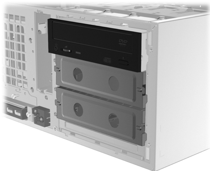
Rysunek 3-9 Ponowna instalacja napędu optycznego
