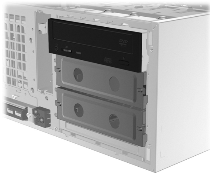
図 3-9 オプティカル ドライブの再取り付け
