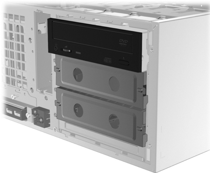
Figura 3-9 Reinstalación de la unidad óptica
