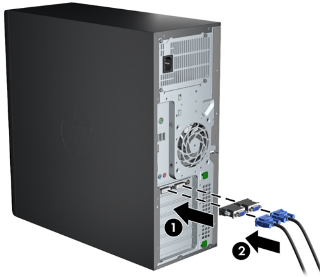
Figura 3-4 Conexión de los cables a la workstation
