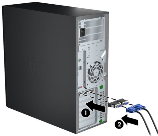
圖示 3-4 將纜線連接到工作站
