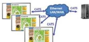
A imagem pode ser estendida em todos os monitores simultaneamente usando a caixa de diálogo "Display Resolution" (Exibir Resolução) da View Span (Extensão da Visualização).
