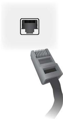
来自显示器的以太网线可以连接到媒体播放器/电脑、路由器（交换机）或内联网。通过网络连接，您可以使用 Video Over Ethernet 软件指定一个媒体播放器来驱动显示器。在联网的媒体播放器/电脑上运行的 HP Network Sign Manager 程序还可以通过该连接发送命令数据。
