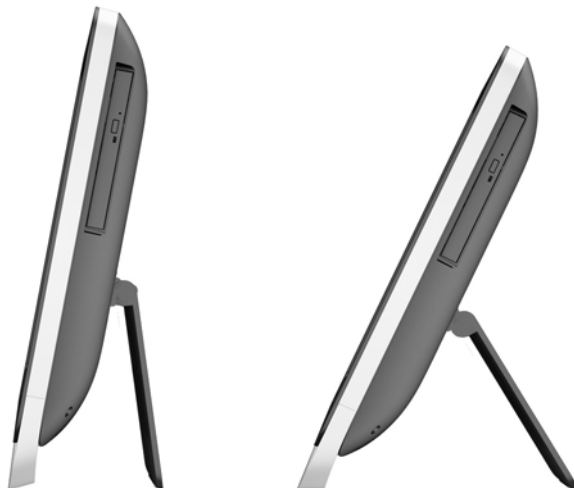
Joonis 1-6 Kalde reguleerimine
