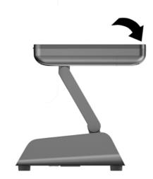
5. Heben Sie die Vorderabdeckung gerade nach oben und vom rückseitigen Gehäuse.
