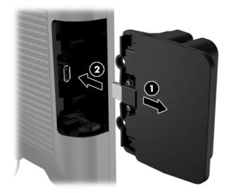
7. Befestigen Sie die Schrauben, die vorher entfernt wurden (1), und schieben Sie die Abdeckung am Modul vorwärts, um die Schrauben zu bedecken (2).
