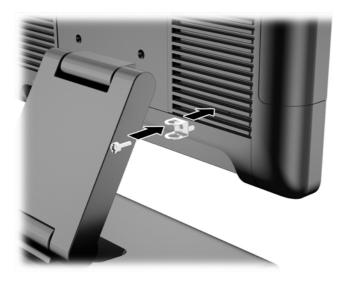
Verbinden Sie ein Kabel, das an einem externen Objekt befestigt ist, mit dem Vorhängeschloss und führen Sie das Vorhängeschloss in die Sicherheitsöse ein. 2.
