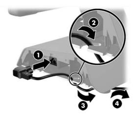
9. Führen Sie das Gleichstromkabel an der linken Seite des Standfußes nach oben durch die Öffnung in der Mitte des Standfußes und schließen Sie das Kabel an den Gleichstromanschluss an der Rückseite des Displaykopfes an.
