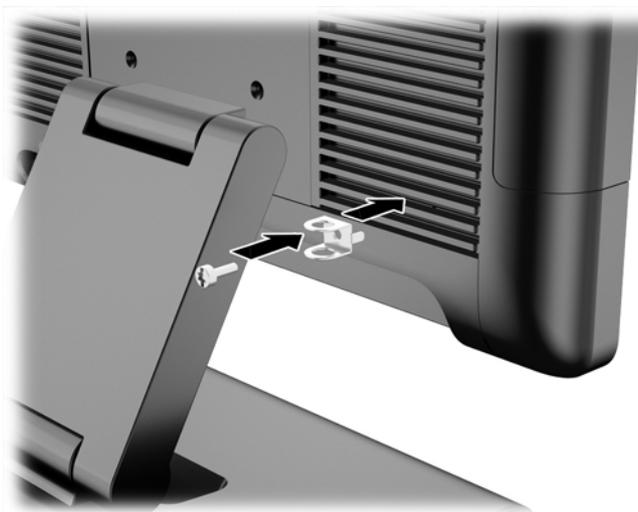
2. Raccordare il cavo collegato all'oggetto esterno al lucchetto e inserire il lucchetto nel supporto di fissaggio.
