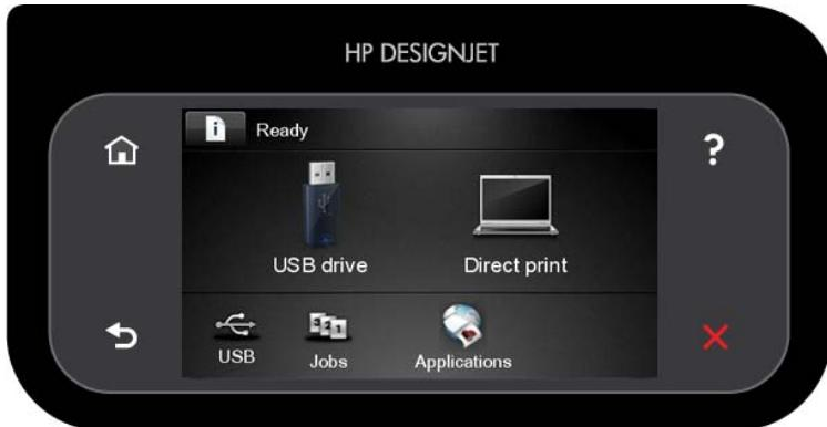
前控制面板有一個大型的中央區域，可顯示動態資訊及圖示。在左右兩邊，您可以在不同時機看到多達六個固定圖示。這些圖示一般不會全部顯示。
