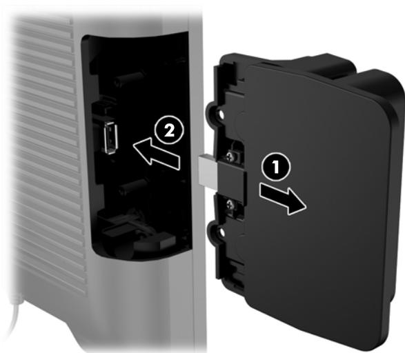
7. 装上之前拆下的两颗螺钉 (1) 并向前滑动模块上的盖板，将螺钉遮盖 (2)。
