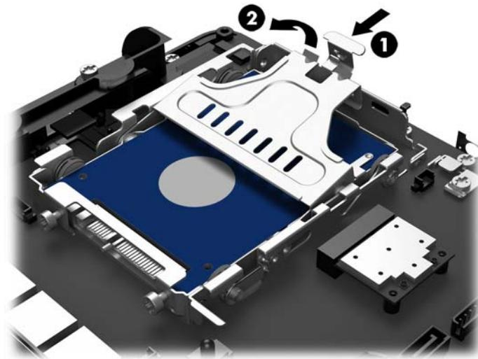
5. Podignite nosač čvrstog diska pravo nagore i izvadite ga iz odeljka za disk jedinicu.
