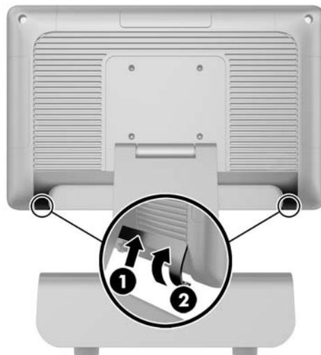
2. Isključite sve kablove iz I/O konektora na zadnjoj ploči, uključujući i kabl za napajanje.
