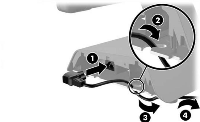
9. Provucite kabl za napajanje jednosmernom strujom sa leve strane osnove nagore, kroz otvor u sredini osnove, i povežite kabl sa konektorom za napajanje jednosmernom strujom sa zadnje strane glave ekrana.
