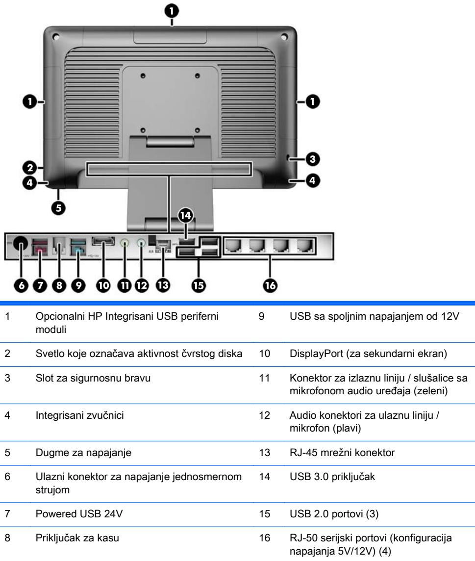
**NAPOMENA:** 24-voltni USB konektor sa spoljnim napajanjem i 12-voltni USB konektor sa spoljnim napajanjem imaju različite priključke da bi se sprečila greška u povezivanju.
