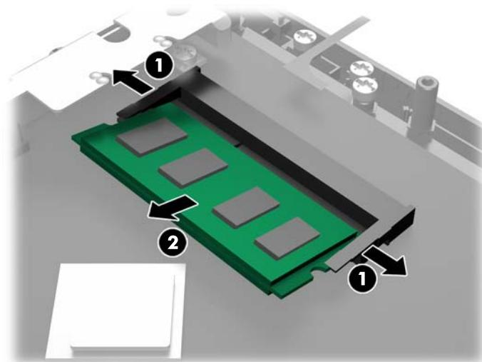
5. Da biste ugradili SODIMM, klizeći ubacite novi SODIMM u ležište pod uglom od približno 30° (1), a zatim pritisnite SODIMM ka ležištu nadole (2) kako bi se reze zaključale u mestu.
