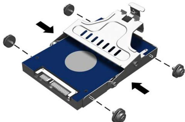
10. Poravnajte zaptivne zavrnje sa slotovima na ležištu za uređaj, ispustite držač pravo u ležiše za uređaj (1), a zatim pritisnite ručicu držača skroz nadole (2) tako da se disk ispravno namesti i fiksira u mestu.
