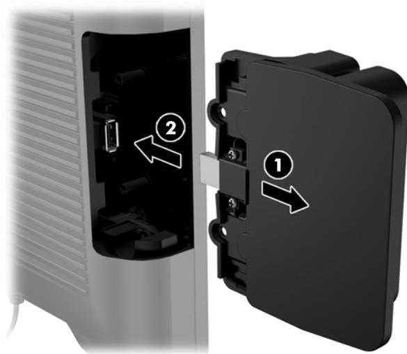
7. Instale los dos tornillos que extrajo previamente (1) y deslice hacia delante la placa de cubierta sobre el módulo para cubrir los tornillos (2).
