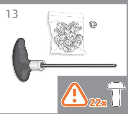
**EL** Μέσα στο κουτί της βάσης υπάρχει ένα κατασβίδι και 22 βίδες: 16 βίδες για τη συναρμολόγηση της βάσης, 4 βίδες για τη σύνδεση της με τον εκπυωτή και **2 βίδες είναι εφεδρικές**. Μην προσπαθήστε να αφαιρέσετε τις ροδέλες από τις βίδες. **Σημείωση:** Όλες οι βίδες προορίζονται για τη βάση. Το καλάθι δεν χρειάζεται βίδες.
