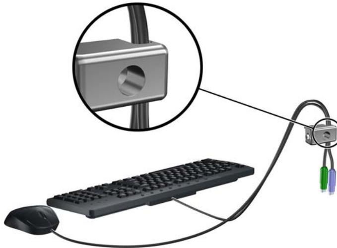
6. Dengan sekrup yang tersedia, kencangkan kunci pada chassis melalui lubang sekrup.
