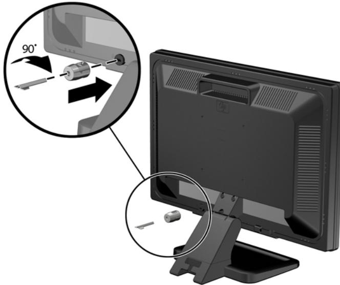
3. Dorong kabel pengaman melalui lubang pada pengunci kabel yang ada di bagian belakang monitor.
