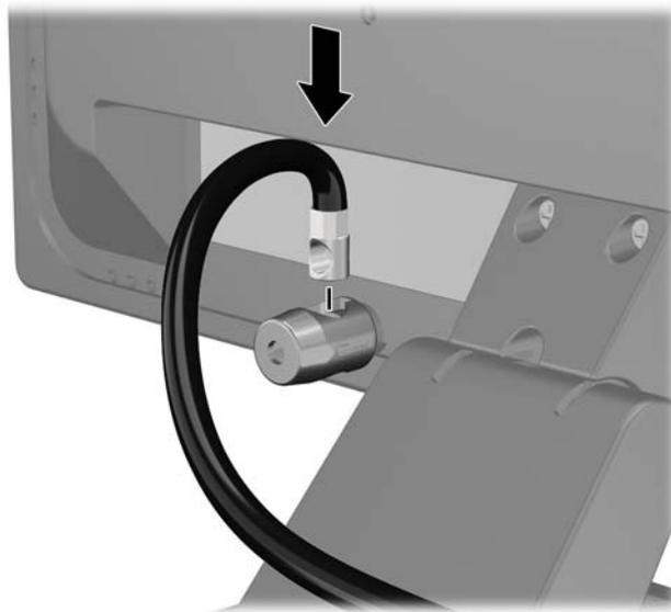
4. Gunakan braket yang tersedia dalam kit untuk mengunci perangkat periferalnya dengan melintangkan kabel perangkat ke bagian tengah braket (1) lalu memasukkan kabel pengaman melalui salah satu dari dua lubang dalam braket tersebut (2). Gunakan lubang dalam braket yang paling kuat mengunci kabel perangkat periferalnya.
