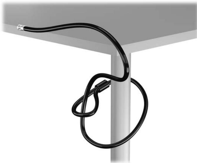
2. Masukkan pengunci kabel ke dalam slot pengunci kabel yang ada di bagian belakang monitor, amankan pengunci ke monitor dengan memasukkan kunci ke dalam lubang kunci di bagian belakang pengunci, dan putar kunci 90 derajat.
