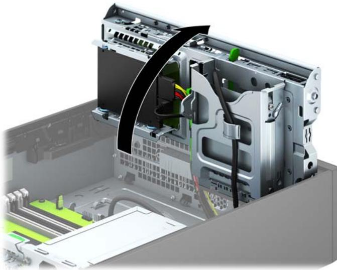
8. Lepaskan kabel drive dari bagian belakang drive. Jika Anda melepaskan pembaca kartu media, lepaskan kabel USB dari papan sistem seperti yang ditunjukkan pada ilustrasi berikut.
