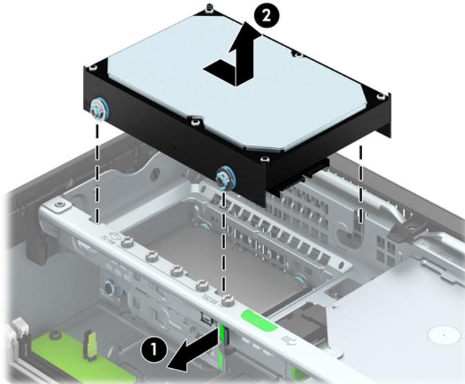
9. Untuk memasang hard drive 3,5 inci, Anda harus memindahkan sekrup pemandu pemasangan terpisah yang berwarna perak dan biru dari hard drive lama ke hard drive baru.
