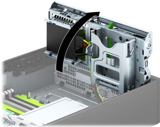
8. Lepaskan kabel daya (1) dan kabel data (2) dari bagian belakang hard drive.
