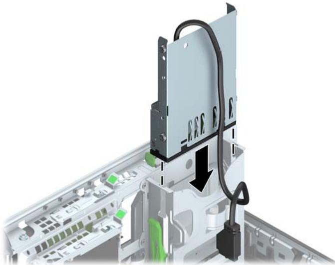
11. Bila memasang pembaca kartu media USB 3.0, Anda harus menggunakan adaptor USB 3.0 ke USB 2.0 (1) dan hubungkan kabel adaptor dari pembaca kartu media ke konektor USB 2.0 pada papan sistem berlabel MEDIA (2).
