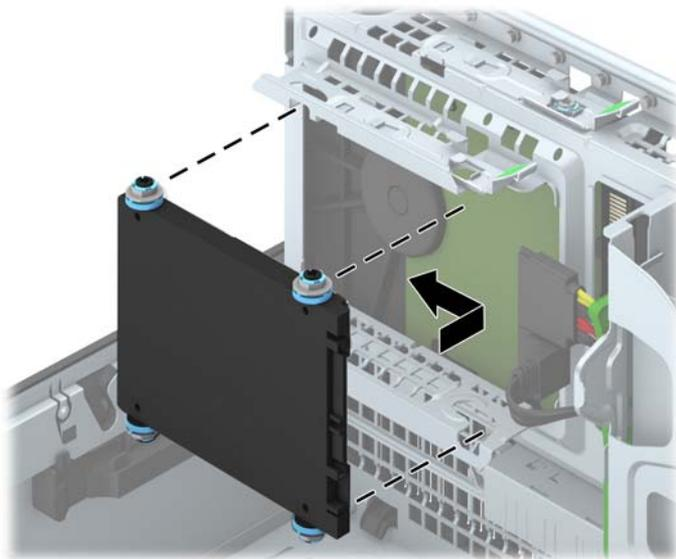
10. Sambungkan kabel daya (1) dan kabel data (2) ke bagian belakang hard drive.
