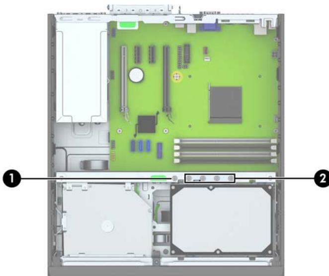
Terdapat total lima sekrup standar 6-32 tambahan berwarna perak. Satu digunakan untuk pengamanan bezel (1) (untuk informasi lebih lanjut, lihat [Keamanan bezel depan pada hal. 46](#)). Keempat sekrup yang lain digunakan sebagai sekrup pemandu untuk pembaca kartu media atau hard drive sekunder di tempat drive 3,5 inci opsional (2).
