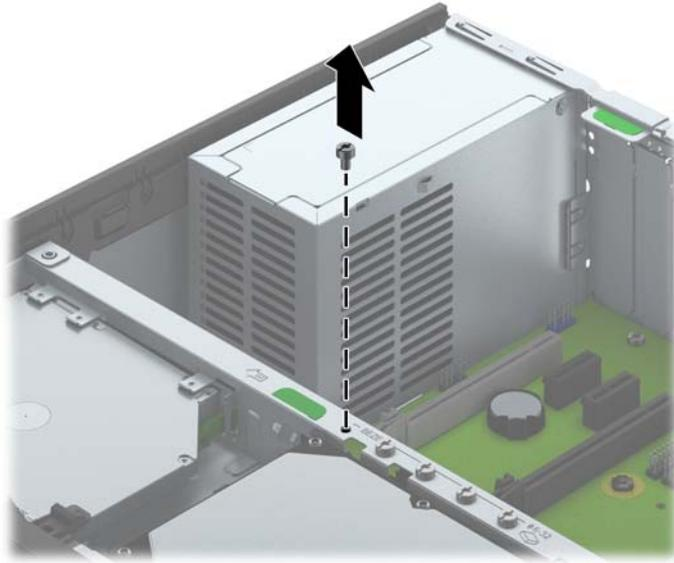
8. Pasang sekrup pengaman melalui bagian tengah tab pelepas bezel depan untuk mengencangkan bezel depan di tempatnya.
