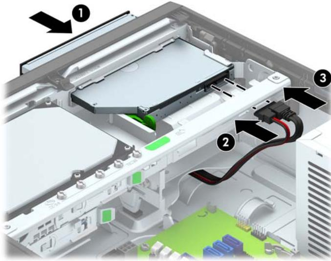
10. Hubungkan ujung lain kabel data ke salah satu konektor SATA berwarna biru muda di papan sistem.
