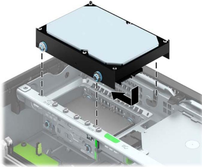
11. Sambungkan kabel daya (1) dan kabel data (2) ke bagian belakang hard drive.
