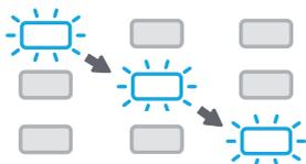
Cuando conecta un dispositivo móvil a la impresora, las luces de selección de papel parpadean en secuencia alrededor de 10 segundos y luego se detienen. El parpadeo de las luces confirma que el dispositivo móvil está conectado a la impresora correcta.
