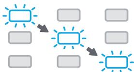
Таке відбувається, якщо підключити до принтера мобільний пристрій. Індикатори блиматимуть протягом 10 секунд, а потім припинять. Таке блимання підтверджує, що пристрій підключено до потрібного принтера.
