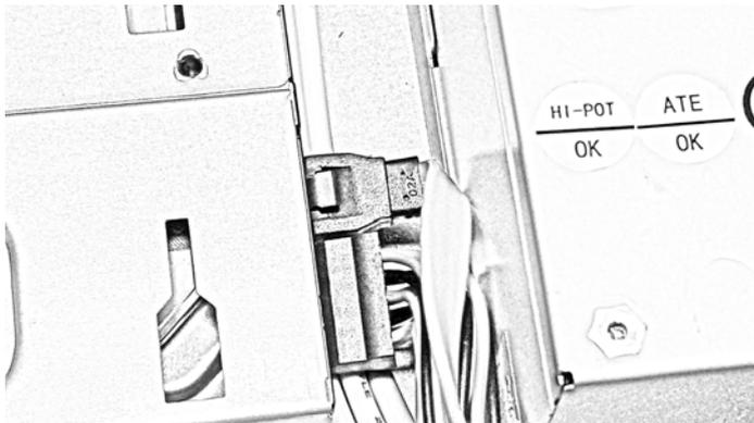
18. Conecte a extremidade oposta do cabo de dados ao conector SATA1 na placa do sistema.
