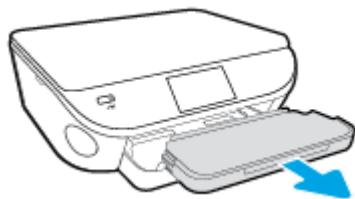
2. В нижней части выходного лотка переместите защелку в разблокированное положение, а затем сдвиньте рычаг, чтобы отсоединить удлинитель лотка.
