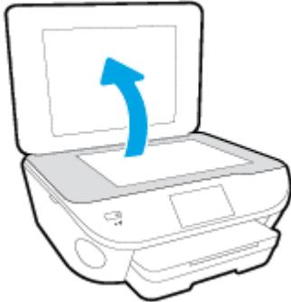
2. Cargue la impresión original hacia abajo en la esquina delantera derecha del cristal.
