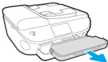
2. 排紙トレイの底部にある排紙トレイ ロックをロック解除位置まで動かし、リリース レバーを持ち上げて延長廃止トレイを解放します。
