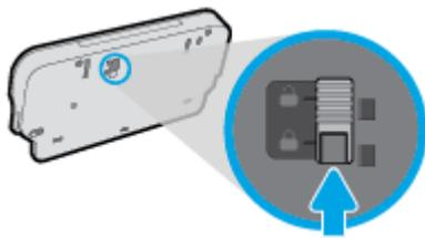
3. Remettez le bac de sortie en place dans l'imprimante en laissant la rallonge dans la position libérée.
