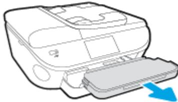
2. Sbloccare il vassoio di uscita spostando il dispositivo di bloccaggio in fondo al vassoio e far scorrere la leva di rilascio per allungare l'estensione del vassoio.
