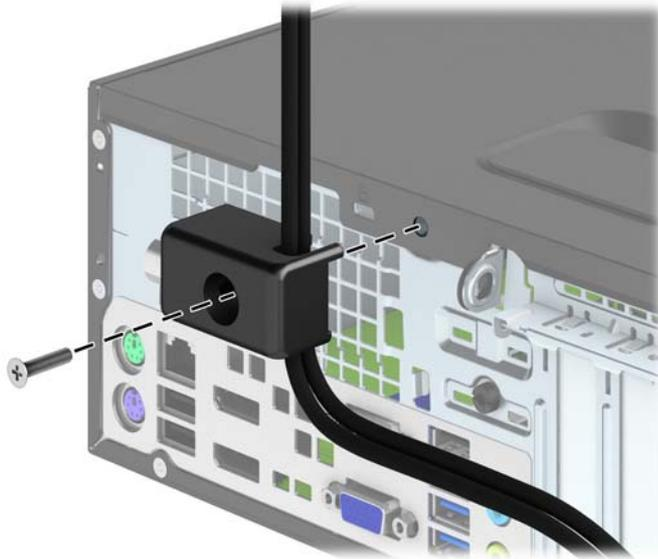
7. Inserte el extremo del cable de seguridad en el bloqueo (1) y presione el botón (2) para activar el bloqueo. Utilice la llave suministrada para desactivar el bloqueo.
