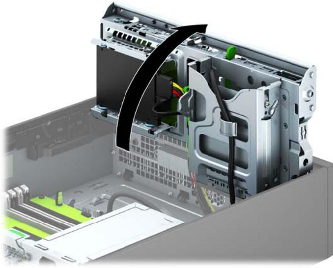
8. Desconecte los cables de la unidad de la parte trasera de la unidad, o si está extrayendo un lector de tarjeta multimedia, desconecte el cable USB de la placa del sistema según se indica en la siguiente ilustración.
