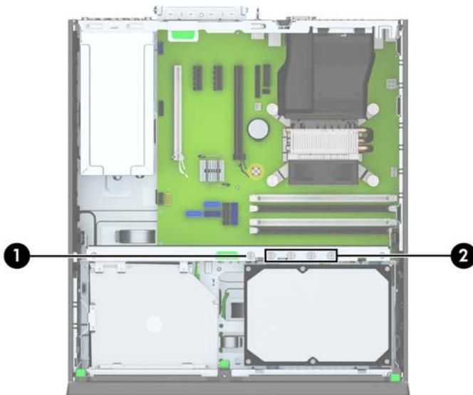
Existe un total de cinco tornillos adicionales 6-32 estándar plateados. Uno se utiliza para asegurar el panel frontal (1) (consulte [Seguridad del panel frontal en la página 47](#) para obtener más información). Los otros cuatro se utilizan como tornillos guía para un lector de tarjetas multimedia o una unidad de disco duro secundaria instalados en el compartimiento de la unidad de disco duro opcional de 3,5 pulgadas (2).
