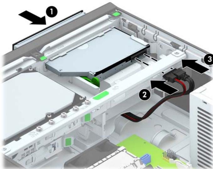
10. Conecte el extremo opuesto del cable de datos en el conector SATA de color azul claro de la placa del sistema.
