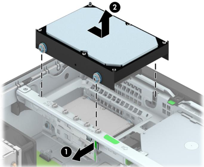
9. Para instalar una unidad de disco duro, usted debe transferir los tornillos guía de montaje de aislamiento plateados y azules de la unidad antigua a la nueva.
