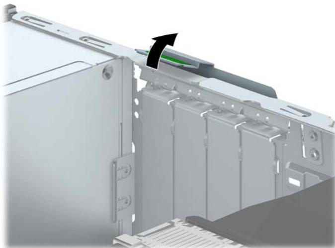
9. Antes de instalar una tarjeta de expansión, extraiga la cubierta de ranura de expansión o la tarjeta de expansión existente.
