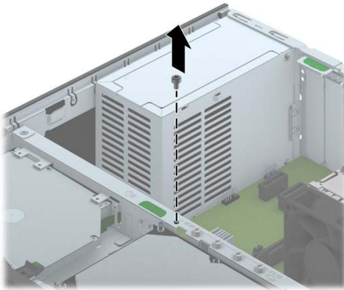
8. Instale el tornillo de seguridad a través de la lengüeta de liberación central del panel frontal para fijar el panel frontal en su lugar.
