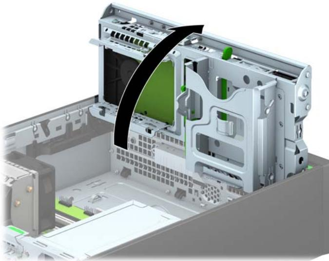
9. Alinee los tornillos guía de la unidad con las ranuras J de los laterales del compartimiento de la unidad. Levante la unidad para introducirla en el compartimento y, a continuación, deslícela hacia delante hasta que encaje en su sitio.
