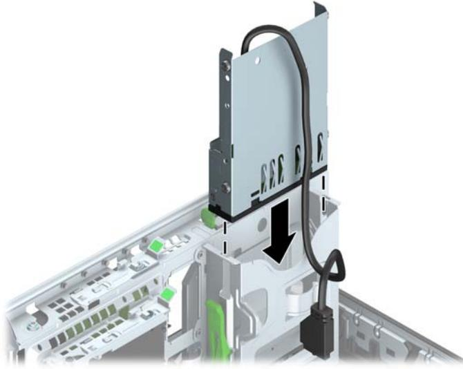
11. Si desea instalar un lector de tarjetas multimedia USB 3.0, conecte el cable USB del lector de tarjetas multimedia al conector USB 3.0 de la placa del sistema rotulado MEDIA3.0.
