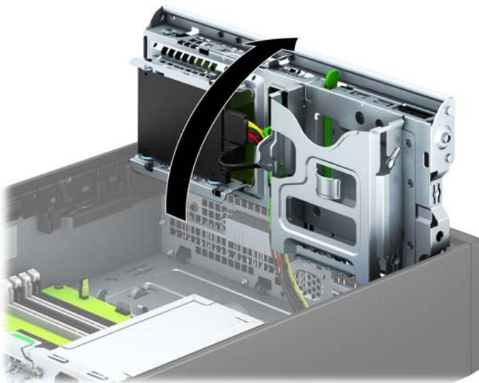
10. Deslice la unidad dentro del compartimiento, asegurándose de alinear los tornillos guía con las ranuras guía, hasta que la unidad encaje en su lugar.
