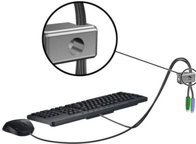
6. Atornille el bloqueo al chasis en el orificio del tornillo de apriete manual utilizando el tornillo suministrado.
