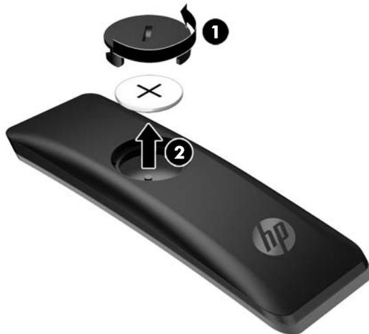
2. Setzen Sie die Batterie mit der Plus-Seite nach oben in das Batteriefach ein (1) und setzen Sie dann die Batterieabdeckung wieder auf (2).
