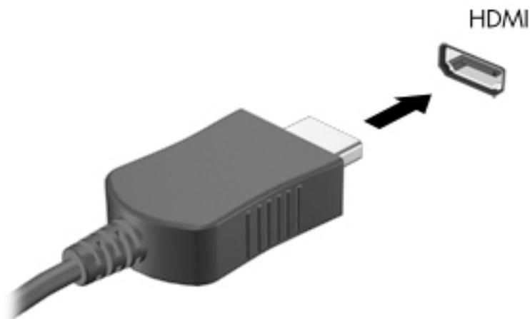
2. Connectez l'autre extrémité du câble au téléviseur ou moniteur haute définition.
