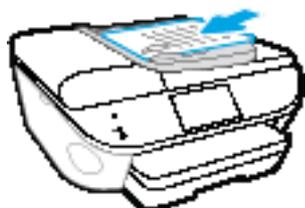
3. Deslice las guías de anchura del papel hacia adentro hasta que entren en contacto con el borde del papel.
