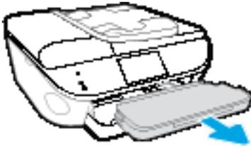
2. En la parte inferior de la bandeja de salida, mueva el bloqueo de la bandeja de salida a la posición de desbloqueo y luego eleve y la palanca de desbloqueo para desbloquear la extensión de la bandeja.
