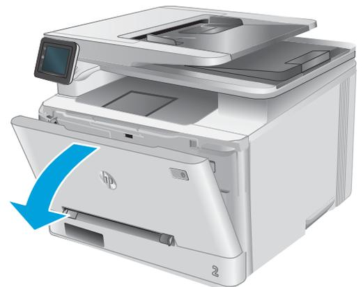
2. Sujete el asa azul del cajón del cartucho de tóner y, a continuación, tire del cajón.
