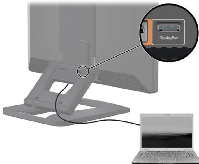
2. Sur le clavier de la station de travail HP Z1 G2, appuyez simultanément sur les touches **Ctrl+Maj+S+D** (*Changer d'écran*) pour permettre à la station de travail d'afficher la sortie de la source graphique externe.
