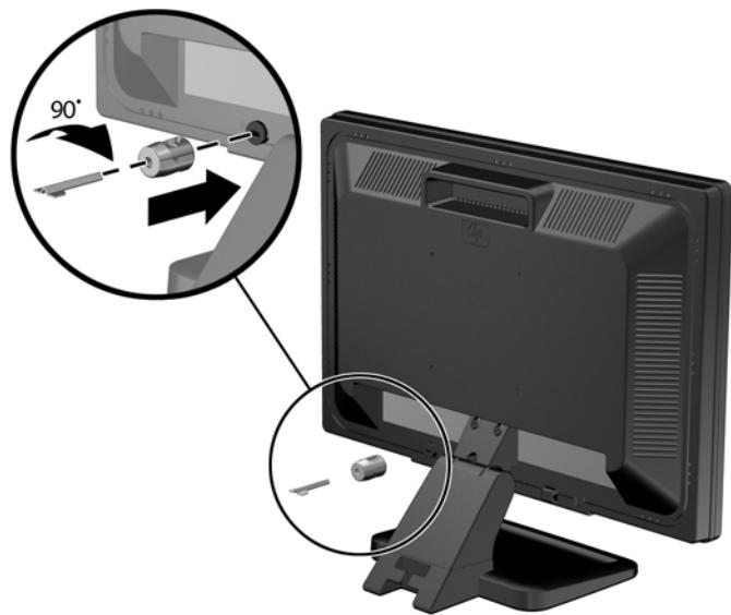
3. 将安全电缆穿过监视器背面的电缆锁孔。
