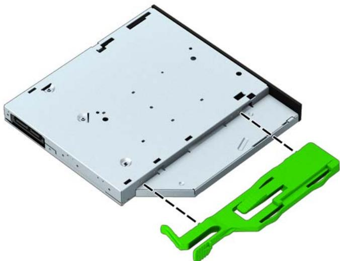
9. 将光驱通过前面板 (1) 径直推入托架中，直到绿色锁定器锁定到机箱框(2)。
