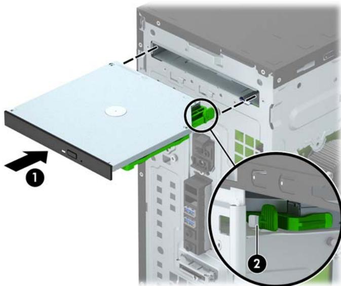
10. 将电源电缆 (1) 和数据电缆 (2) 连接到光驱背面。
