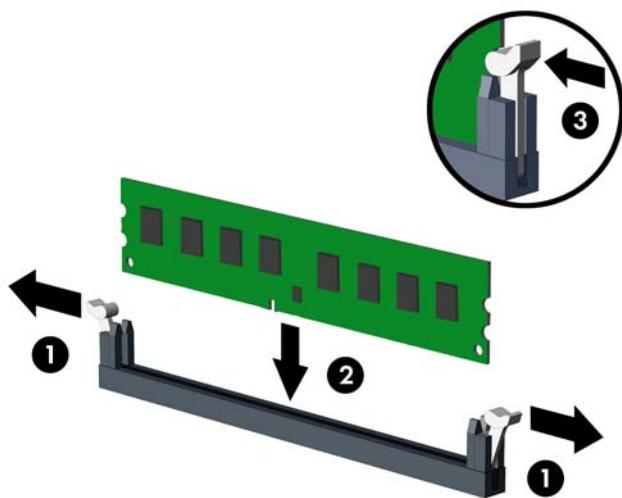
**注：**内存模块只能以一种方式安装。将模块上的凹槽与内存插槽上的卡舌对准。
