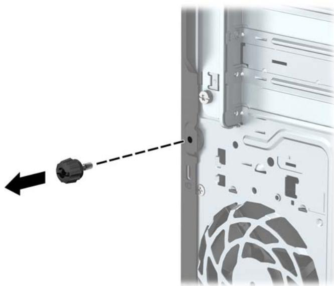
7. 使用附带的螺钉通过翼形螺钉孔将锁固定到机箱上。
