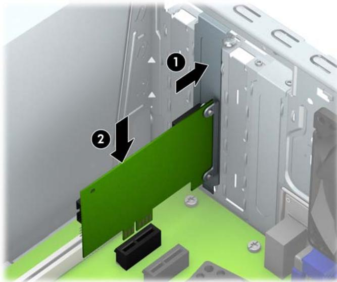
**注 :** 安装扩展卡时 , 请用力按压扩展卡 , 以使整个连接器在扩展卡插槽中正确就位。
