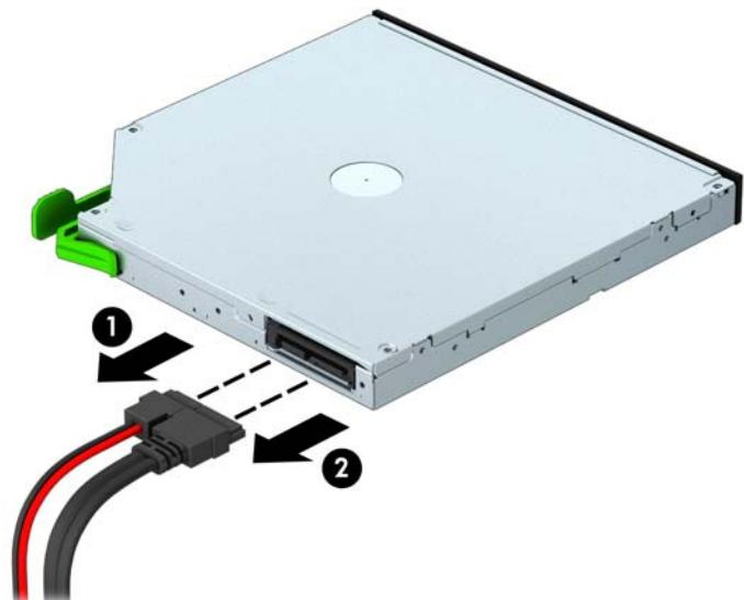
**⚠ 注意：**拔下电缆时，请拉动卡舌或连接器而非电缆本身，以避免损坏电缆。
