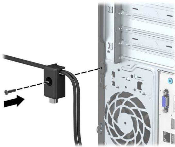
8. 将安全保护缆锁一端的插头插入钳锁中 (1) , 然后按 (2) 所示方向推按钮以锁上钳锁。使用附带的钥匙可以打开该锁。
